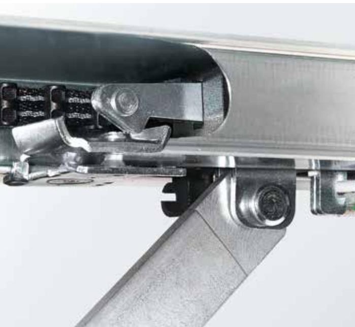
**SEGURO.** Si la puerta de garaje está cerrada, la protección contra apalancamiento se enclava automáticamente en el anclaje del carril-guía, y la puerta queda bloqueada y protegida al instante. Dos ganchos adicionales en el extremo de la puerta unen la hoja al cerco lateral.
