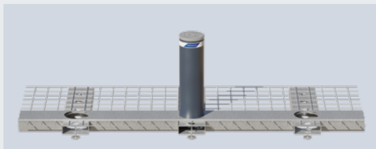
Fijación de suelo estándar con 1 cilindro fijo (disposición en dirección de marcha central), opcionalmente derecha e izquierda
