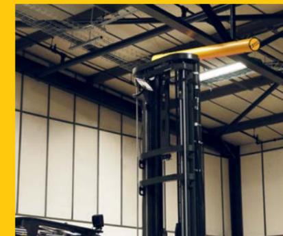
El Alarm Bar proporciona una guía visual al conductor.
