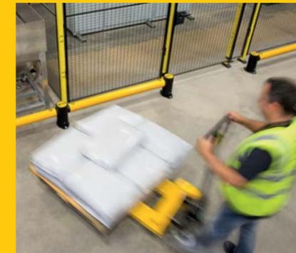
Barrera de protección industrial Simple Traffic mFlex: protege el vallado metálico contra traspaleas a bajo nivel.
